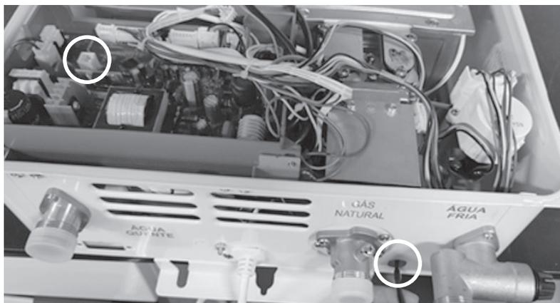
3. Insira o terminal do controle remoto no módulo de comando como na imagem e em seguida, use a fita para amarrar o fio na posição indicada pela seta da imagem para evitar a remoção.
