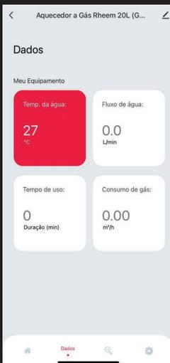
Dados de consumo de gás, temperatura da água em tempo real, fluxo de água, tempo de uso do aparelho
