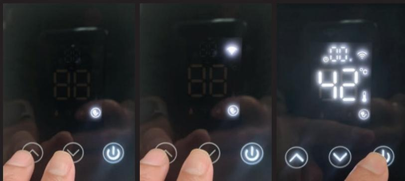
1º Com o display do aquecedor na posição desligado, pressione simultaneamente as setas de temperatura até aparecer o **ícone de wi-fi** e este começar a piscar e em seguida ligar o display.
