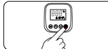
Desligue o aquecedor de água, pressionando o botão ON/OFF no painel de controle.
