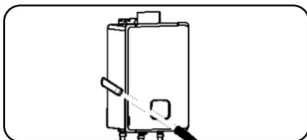
Utilize o aspirador de pó em torno do aquecedor para remover qualquer poeira, sujeira e/ou fios.
