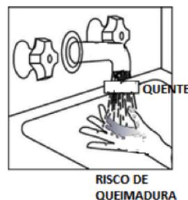
Água com temperaturas acima de 50°C pode causar graves queimaduras instantaneamente ou morte por escaldamento. Crianças, deficientes e idosos correm um risco maior de sofrerem queimaduras. Verifique o manual de instruções antes de definir a temperatura do aquecedor de água. Sinta a temperatura da água antes de tomar banho. Válvulas delimitadoras de temperatura estão disponíveis, verifique o manual.
