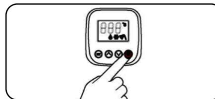
Desligue o aquecedor pressionando o botão ON/OFF no display.
